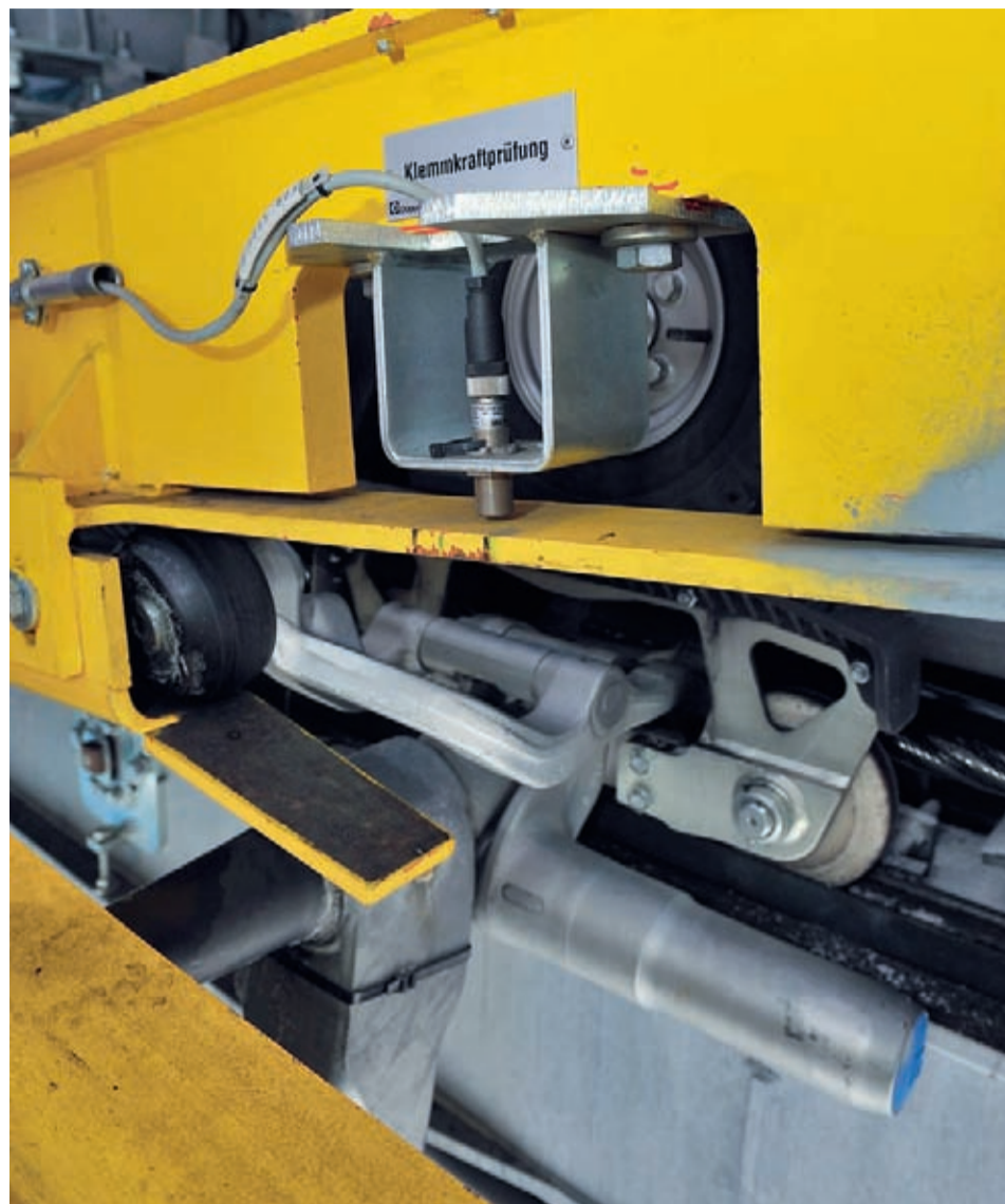
Mit der Klemmkraftprüfung wird kontrolliert, ob mit der vorgeschriebenen Kraft die Klemme auf das Förderseil geklemmt wird. Ist dies nicht der Fall, wird die Bahn automatisch abgeschaltet.
