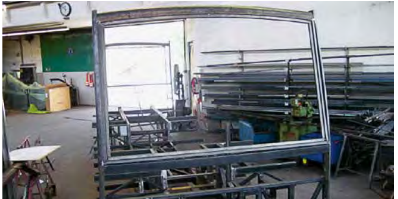
Der neue E-Bus der Linie Bergbahnen im Rohbau.
