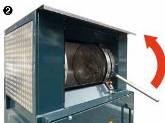
2 Abfallsack in die Öffnung legen und Bedienungshobel nach oben schwenken. (aus Sicherheitsgründen max. 10 kg)
