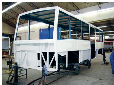
Erste Bleche werden montiert.
