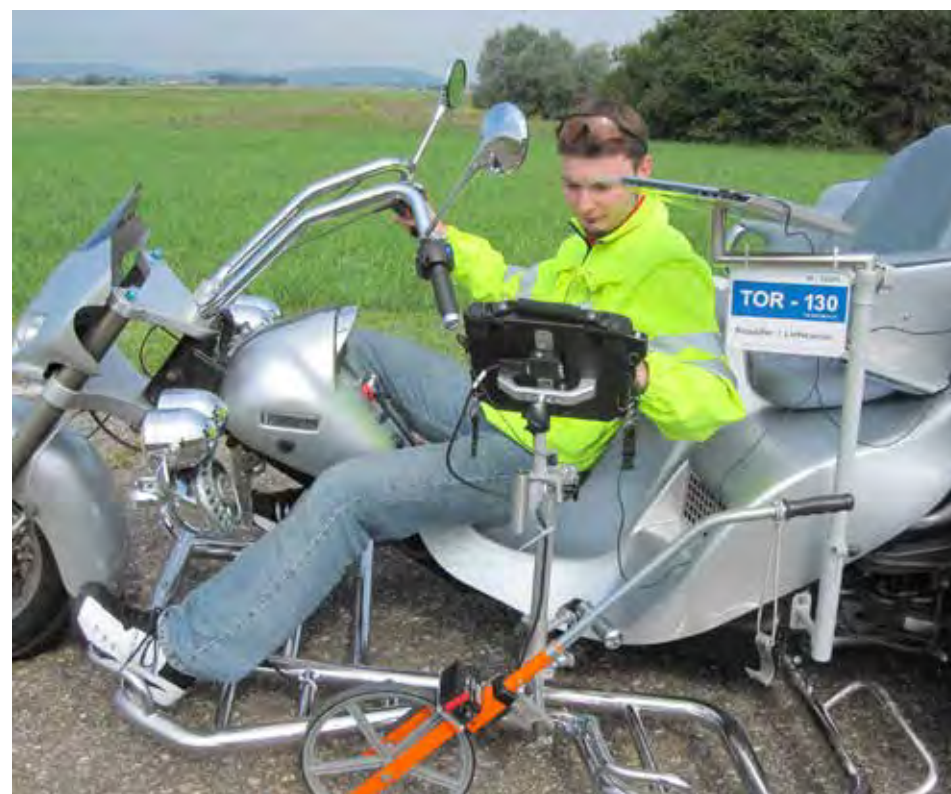
Zur Bestandsaufnahme der Strasseninfrastruktur in Zermatt wird ab dem 25. August 2014 für rund eine Woche ein besonderes Gefährt eingesetzt.
