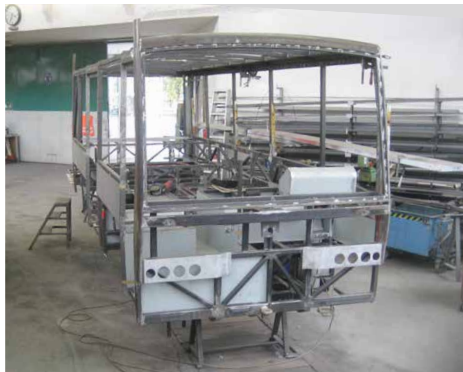
Der Rohbau des neuen Elektrobusses ist zwischenzeitlich abgeschlossen.
