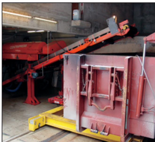
In der Centripresse wird der Frischschlamm bis zu 30 % entwässert, bevor er in die Lonza nach Visp transportiert wird.
